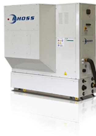
**Groupes d'eau glacée et pompes à chaleur réversibles monobloc avec condensation par air et ventilateurs Plug-Fan avec moteur EC. Série à compresseurs hermétiques type scroll DC inverter et gaz réfrigérant R410A.**
